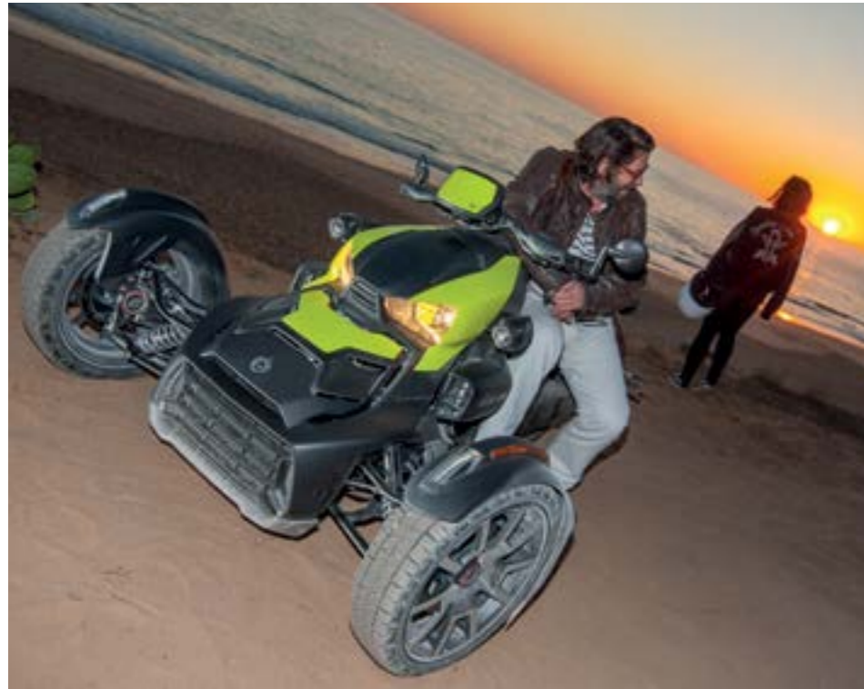
Y-Architektur: 2 Räder vorne, eins hinten, dazwischen der Motor und der Sitz für den Piloten, optional auch für die Sozia
